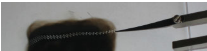
Abbildung 7.3: Sichtbarmachen von Schallschwingungen auf einer beruhten Plexiglasplatte.
