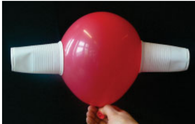
Abbildung 7.6: Der Luftballon mit Ohren: Aufgrund eines erzeugten Unterdrucks in den Bechern werden diese vom äußeren Luftdruck an den Luftballon gedrückt.
