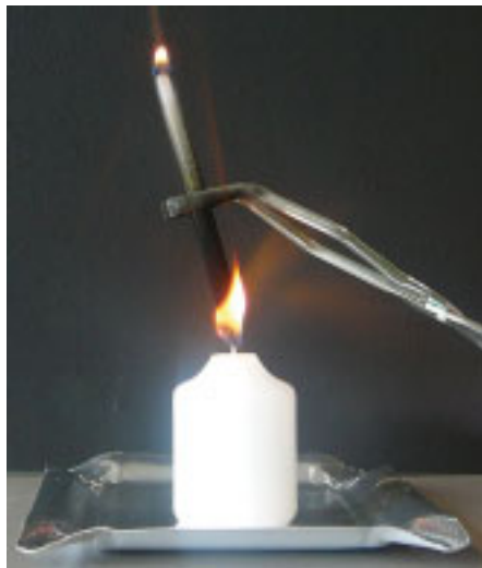
Abbildung 7.8: Die Tochterflamme: Wachsämpfe einer brennenden Kerze (weißer Rauch) werden durch ein Glasrohr abgeleitet und am oberen Ende entzündet.
