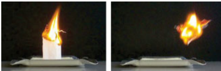
Abbildung 7.7: Die Teebeutelrakete: Der abbrennende Teebeutel klappt nach innen. Dabei formt sich ein Aschenetz, unter dem sich die warme Luft sammelt und den beinah abgebrannten Teebeutel mit nach oben trägt.
