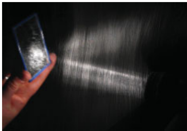
Abbildung 7.2: Reflektion eines Lichtstrahls an einem Spiegel, sichtbargemacht mit Baby-Puder.
