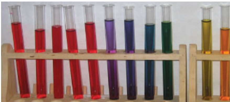
Abbildung 7.9: Die unterschiedlichen Farben des Rotkohllindikators von stark sauer (links) bis stark alkalisch (rechts).
