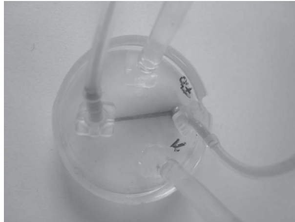
Abbildung 28: Mikrofluidischer Bioreaktor mit gekrümmtem porösem Mikrokanal. Eine Farblösung (Kristallviolett) wurde über die Einlassöffnungen durch den porösen Mikrokanal gepumpt (Pumpsystem, Ibidi). Der Farbstoff gelangte durch die Poren im Kanal in das untere Kompartiment.
