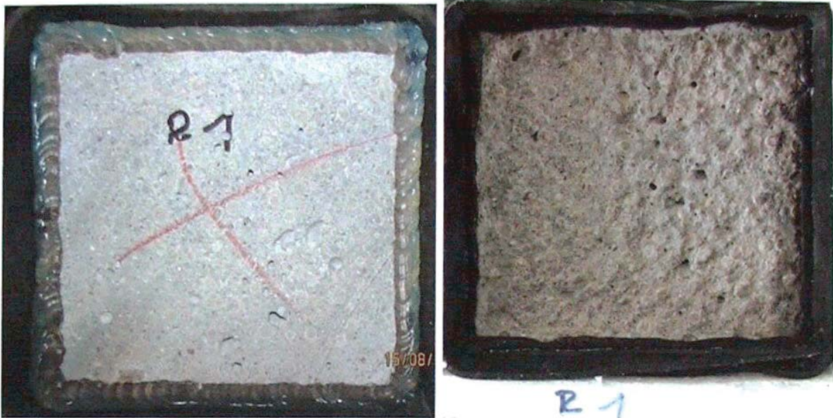
Abb. 6: Probe R1, links: vor der Frostbeanspruchung und rechts: nach der Frostbeanspruchung
