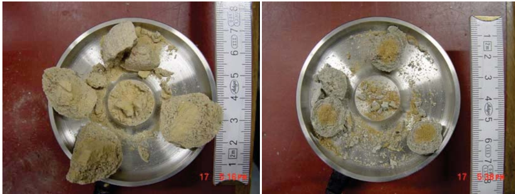
Abbildung 4.26. Erhärtete Agglomerate mit Sandbrocken als Kern nach der Einzelkorndruckprüfung; links VV3 mit Sand K2 im Kern; rechts VV4 mit Sand D2 im Kern
