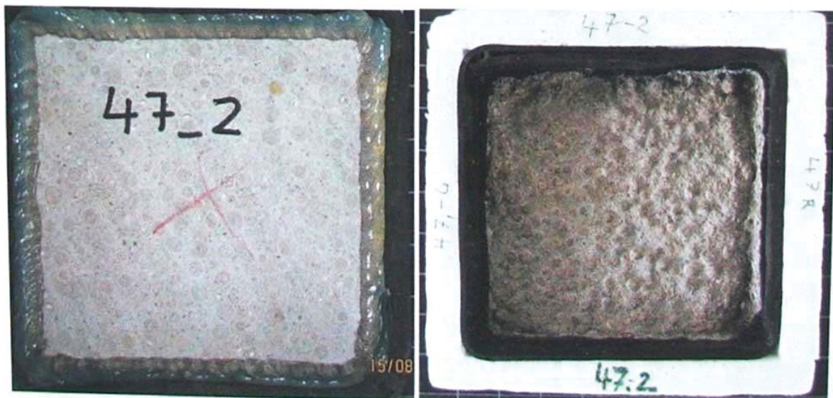
Abb. 11: Probe 47-2, links: vor der Frostbeanspruchung und rechts: nach der Frostbeanspruchung
