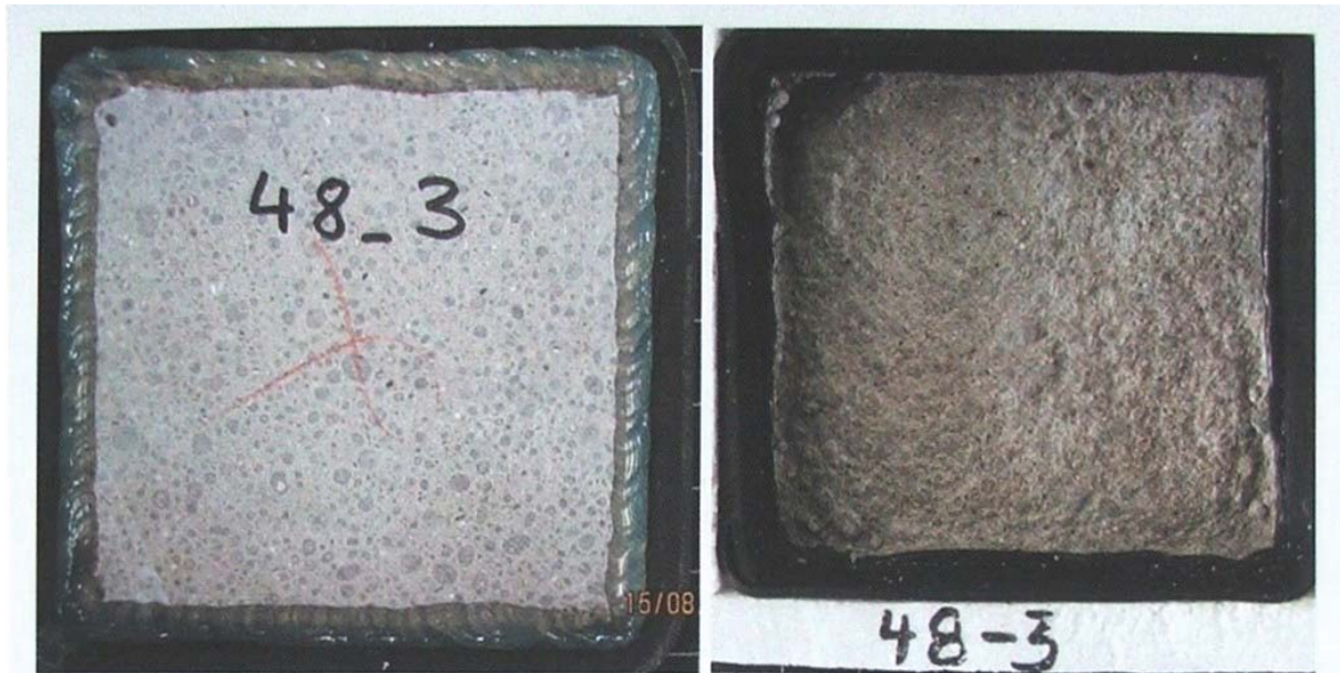
Abb. 12: Probe 48-3, links: vor der Frostbeanspruchung und rechts: nach der Frostbeanspruchung
