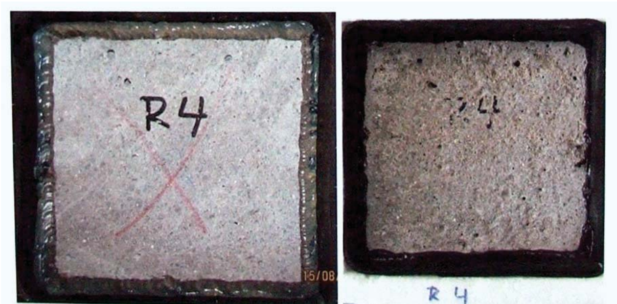
Abb. 9: Probe R4, links: vor der Frostbeanspruchung und rechts: nach der Frostbeanspruchung
