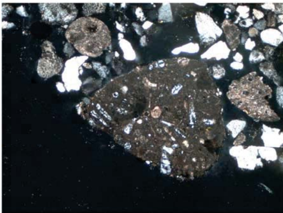
Evtl. magmatisches Korn, Quarzkristalle eingebettet, gekreuzte Polarisatoren(links) linear polarisiertes Licht(rechts), 40x Vergrößerung, BB 2 mm
