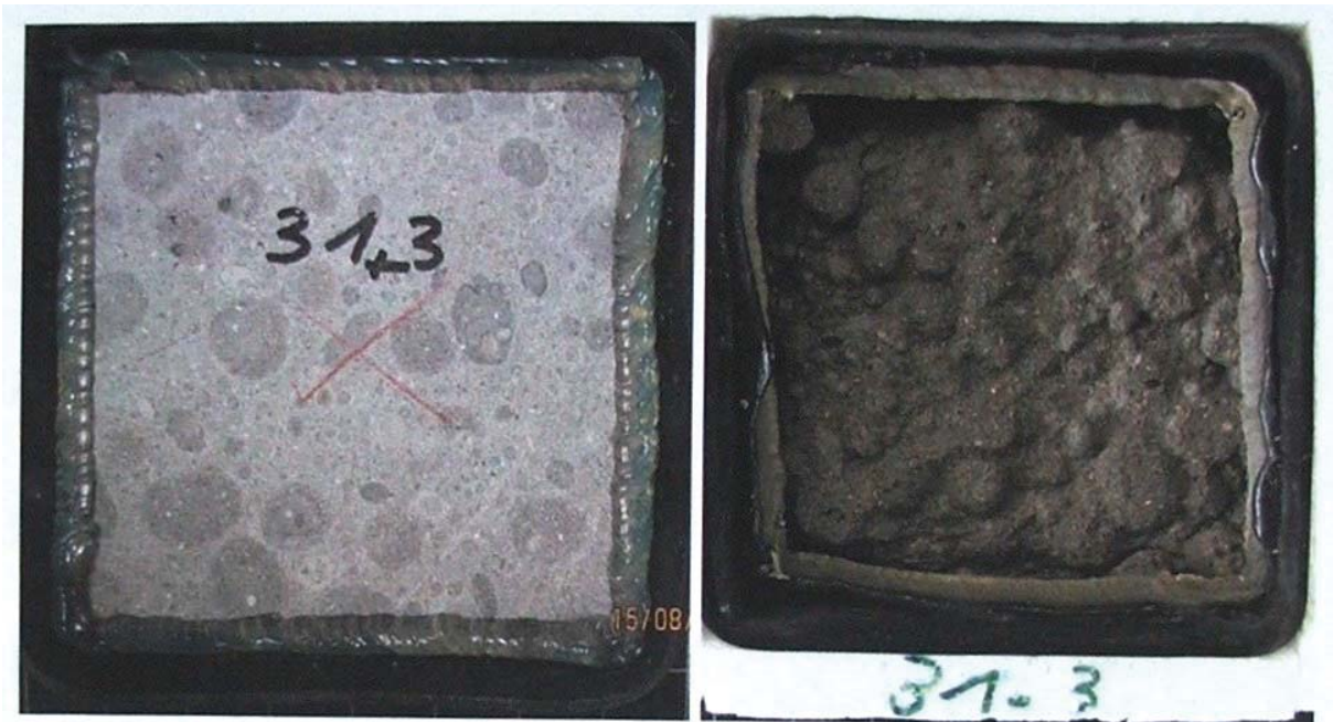
Abb. 10: Probe 31-3, links: vor der Frostbeanspruchung und rechts: nach der Frostbeanspruchung
