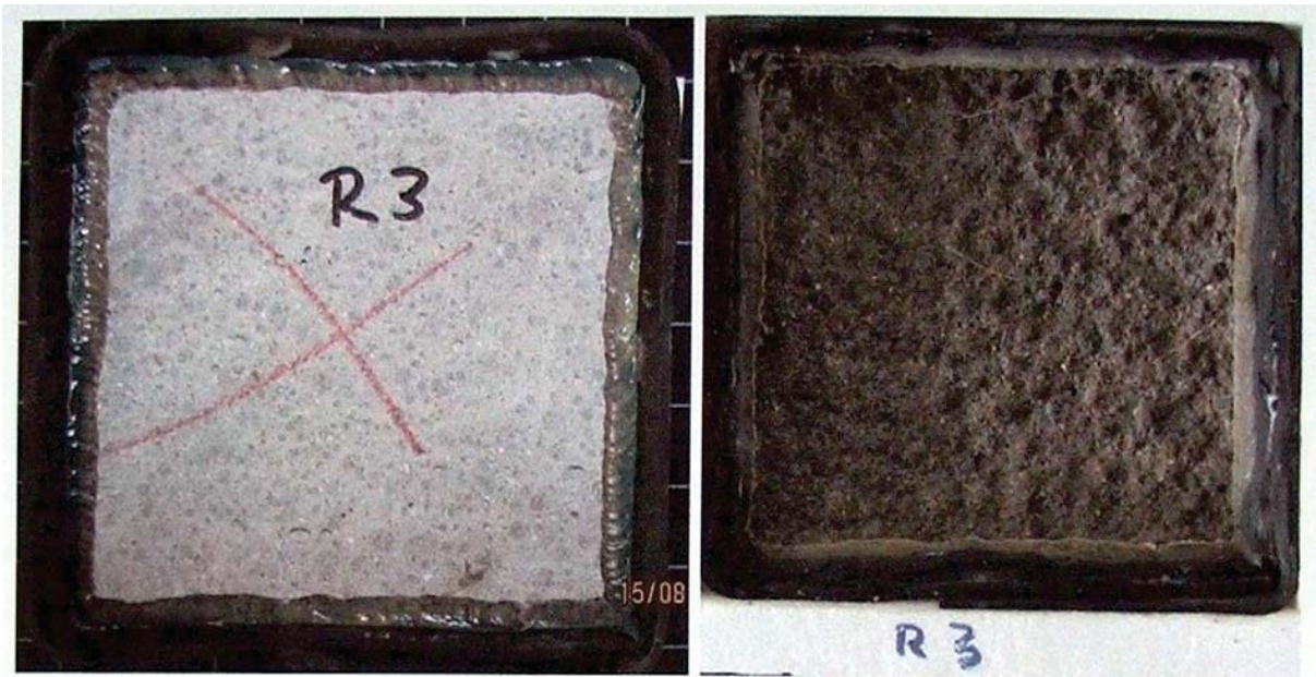
Abb. 8: Probe R3, links: vor der Frostbeanspruchung und rechts: nach der Frostbeanspruchung
