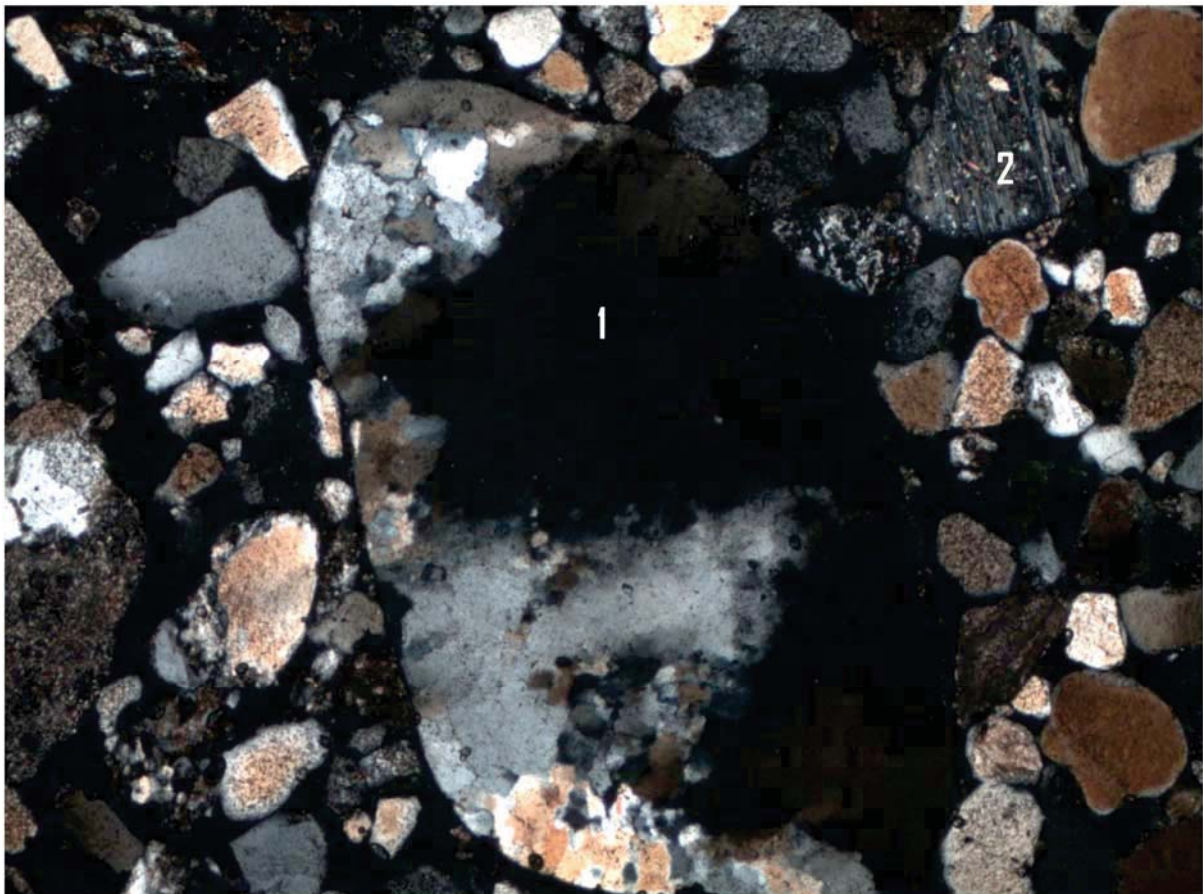
Quarzkorn mit Mikrokristallbildung und undulöser Auslöschung (1), stark alterierter Plagioklas (2) mit polysynthetischen Zwillingen und Glimmer Verwachsungen. gekreuzte Polarisatoren, 40x Vergrößerung, BB 2 mm
