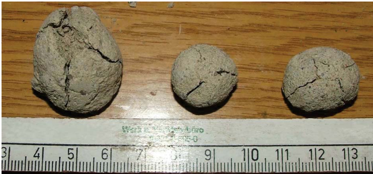
Abbildung 4.54: Typische Bruchbilder erhärteter Agglomerate
