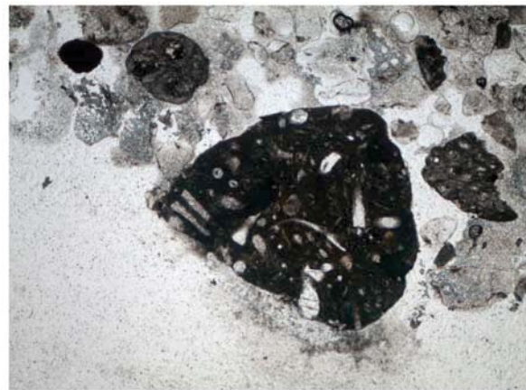
Evtl. magmatisches Korn, Quarzkristalle eingebettet, gekreuzte Polarisatoren(links) linear polarisiertes Licht(rechts), 40x Vergrößerung, BB 2 mm
