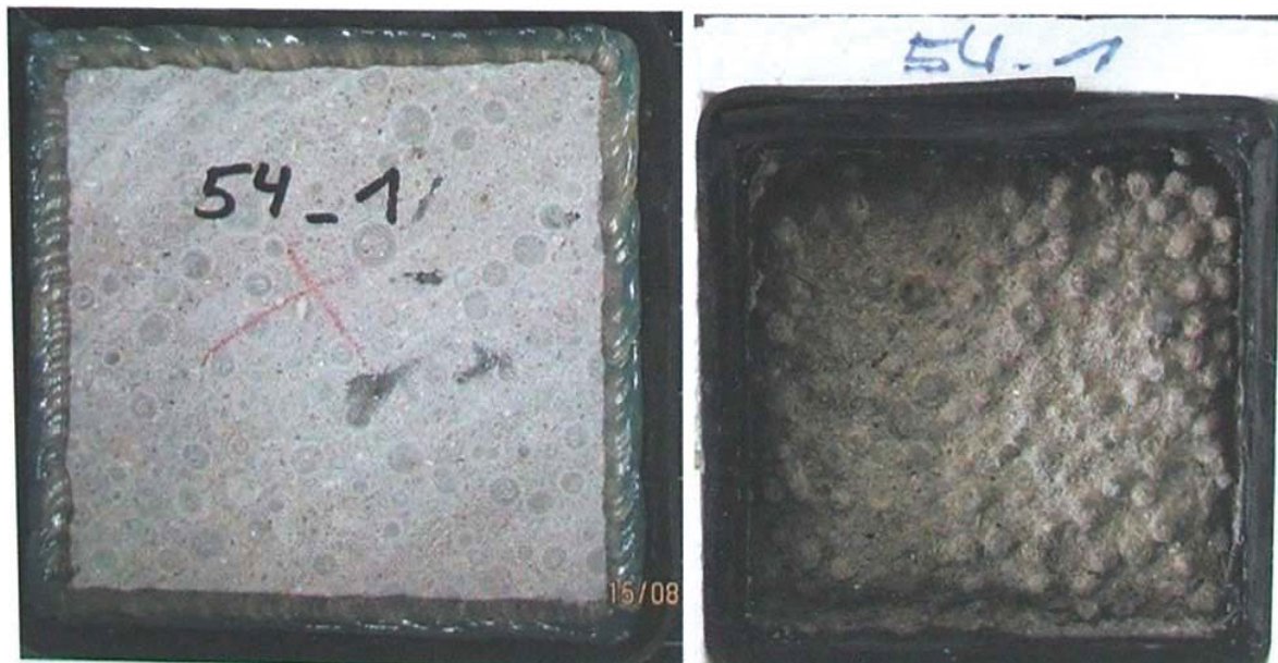
Abb. 13: Probe 54-1, links: vor der Frostbeanspruchung und rechts: nach der Frostbeanspruchung
