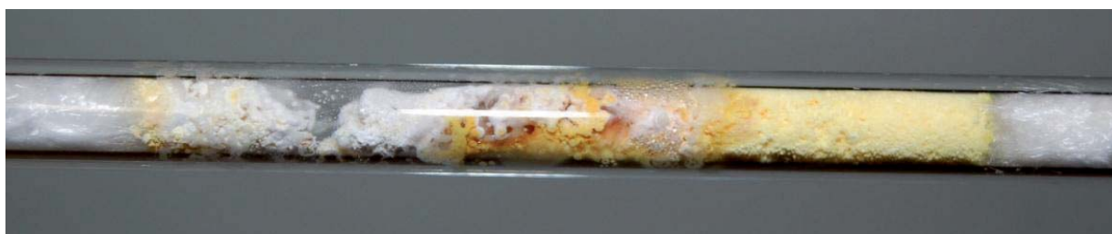
Abbildung 87: Partielle Rotfärbung von Kaliumhyperoxid durch den thermischen Verfall in Sesquioxide
