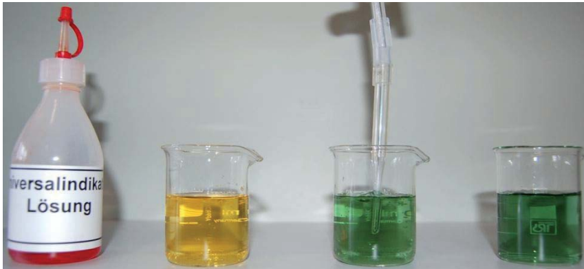
Abbildung 88: Qualitative Untersuchung des gasförmigen Reaktionsprodukts mit Universalindikator
