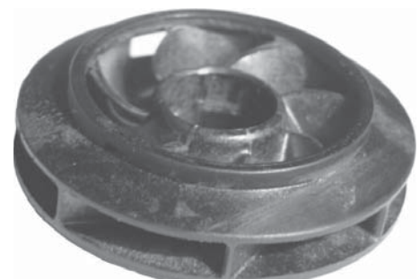
Abbildung 2.15: Mit Hilfe von Glaskernen im Druckguss hergestelltes Flügelrad mit einem Durchmesser von 50 mm nach Raab et al. [21].
