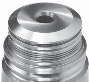
Abbildung 2.7: Mechanischer Einfallkern der Firma Föhl, wie er von Ziegler und Schwab [7] beschrieben wird. Die sechs außen liegenden Einfallelemente sind um den zentralen, nach hinten ziehbaren Kern gruppiert.
