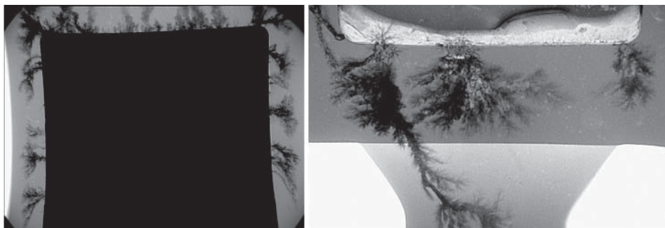
Abbildung 2.16: Röntgenbilder eines Gussteils aus \text{AlSi9Cu3} mit eingedrunenem Kernmaterial nach Kugel und Bürig-Polaczek [20]. Links ist der metallische Kern noch nicht ausgeschmolzen. Zu erkennen sind einzelne Bereiche, in denen lokal aufgeschmolzenes Kernmaterial auch entgegen der Schwerkraft in das Gussteil gelangt. Auf der Rechten ist der Kern ausgeschmolzen. Hier wird ersichtlich, dass das Kernmaterial bis in den Anschnitt- und Gießlaufbereich in das Gussteil eindringt.
