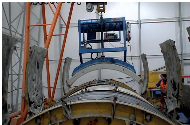
Abbildung 163 Ausschalen des Tübbings
