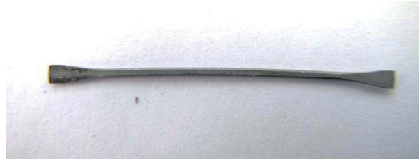
Abbildung 9 Stahldrahtfaser mit Flachgedrückten enden
