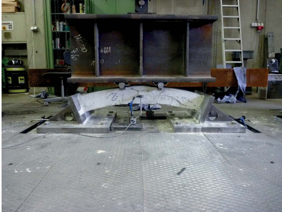
Abbildung 140 Foto des Bruchbildes von Tübbing T2-2
