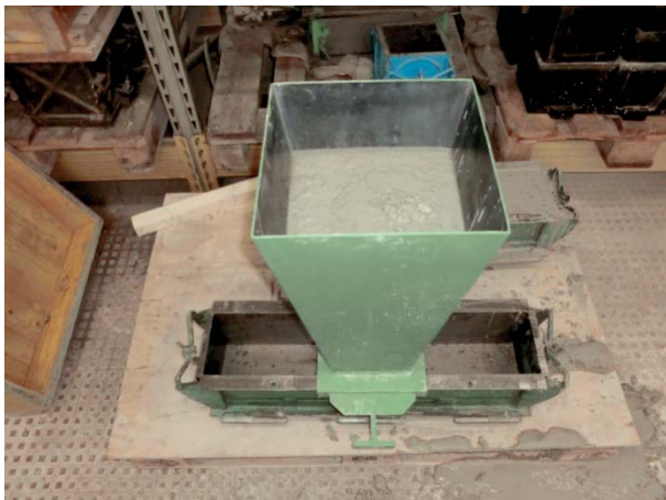
Abbildung 116 Befüllen der Balkenform über den Trichter in der Mitte
