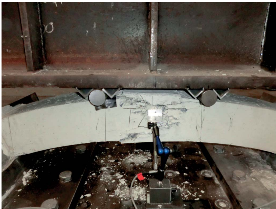
Abbildung 152 Foto des Bruchbildes von Tübbing T2-8
