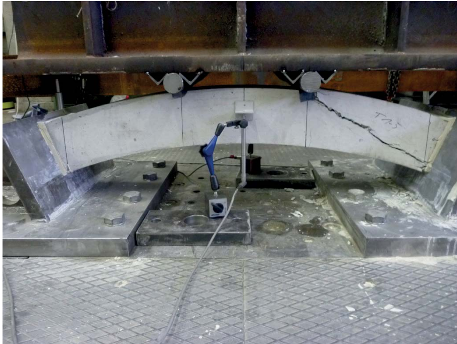
Abbildung 134 Foto des Bruchbildes von Tübbing T1-5
