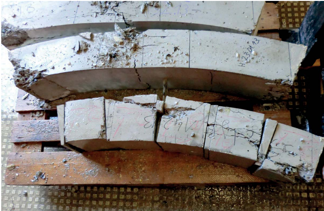
Abbildung 123 Tübbing nach Prüfung zersägt um die Faserorientierung zu messen
