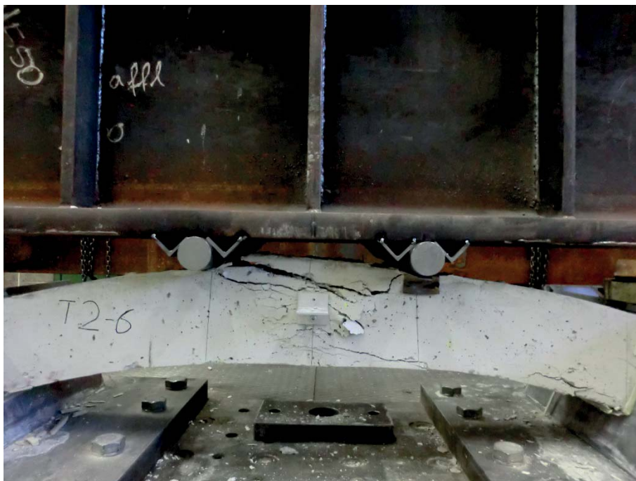
Abbildung 148 Foto des Bruchbildes von Tübbing T2-6
