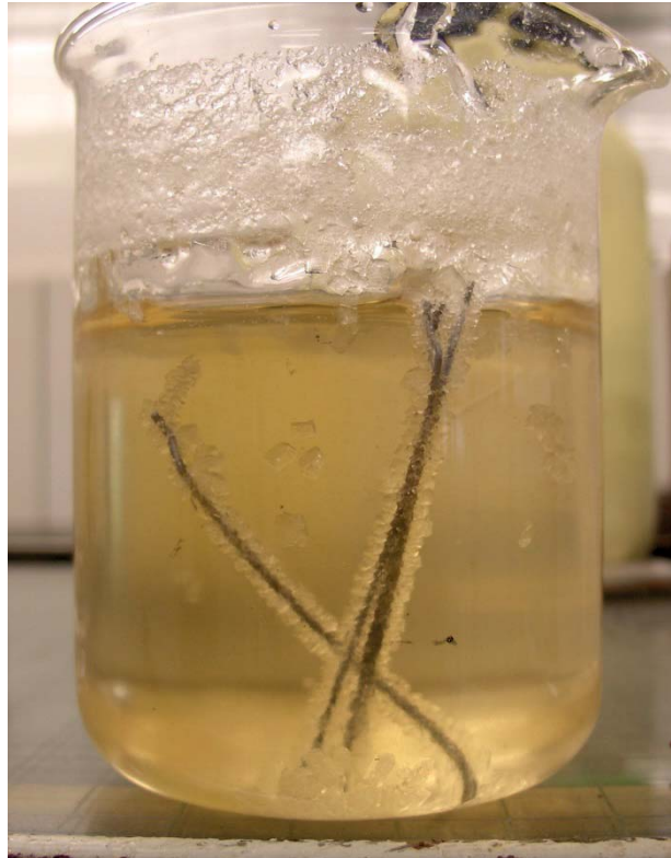
Abbildung 20 Auskristallisieren von Zucker an der Faser
