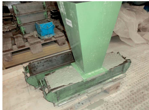
Abbildung 117 Befüllte Balkenform mit dem Trichter in der Mitte
