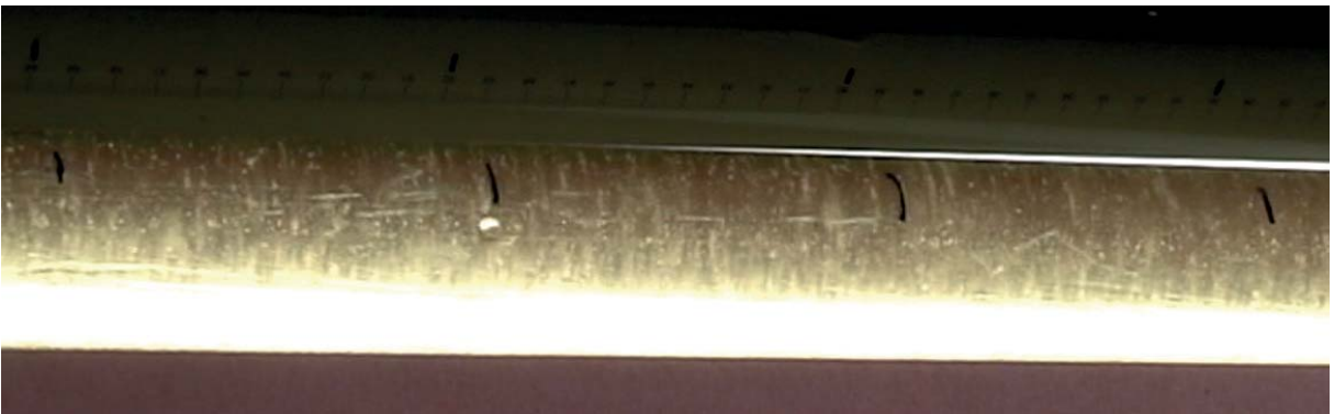
Abbildung 50 Geschwindigkeitsmessung mit einer Luftblase – 17 Sekunden
