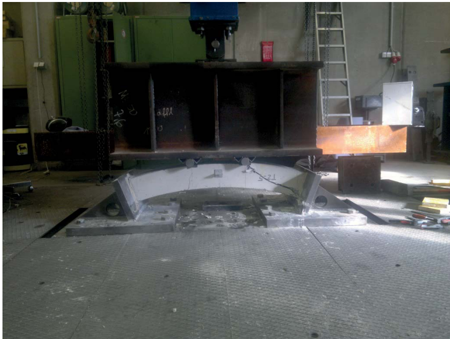
Abbildung 146 Foto des Bruchbildes von Tübbing T2-5
