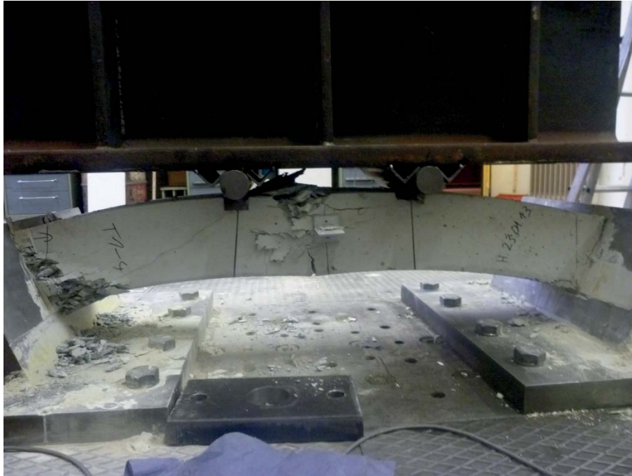
Abbildung 132 Foto des Bruchbildes von Tübbing T1-4
