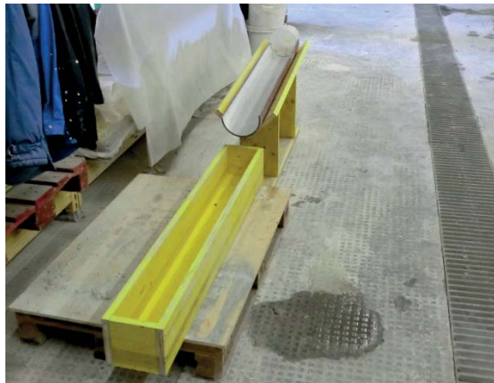
Abbildung 110 Befüllung der doppelt so langen Balkenform mit der Rinne am Ende
