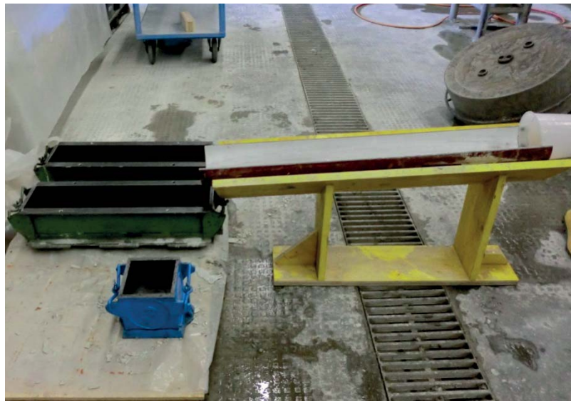
Abbildung 92 Versuchsanordnung zum Einfüllen des Betons über eine Rinne am Ende der Balkenform
