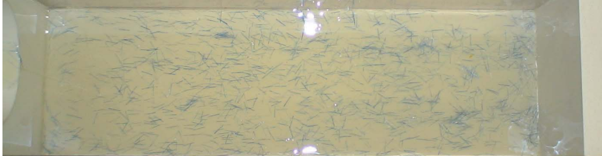
Abbildung 32 Faserorientierung mit blau eingefärbten PP-Fasern
