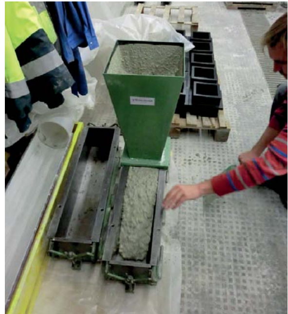
Abbildung 114 Befüllung der Balkenform mit dem Trichter am Ende
