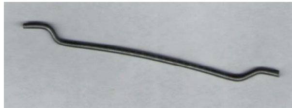
Abbildung 10 Stahldrahtfasern mit Endverankerung (Foto: Krampeharex)
