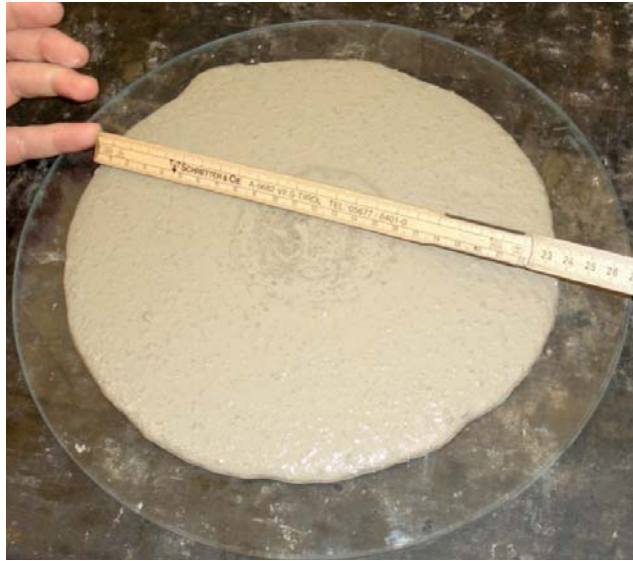
Abbildung 23 Fließmaß des SCC-Mörtels
