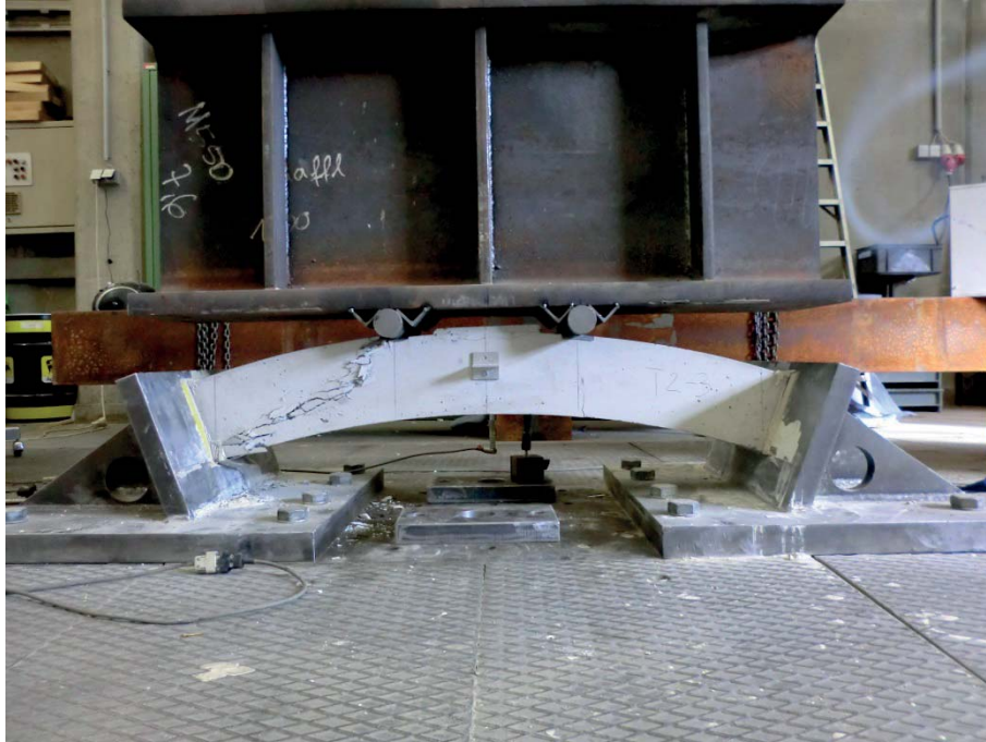
Abbildung 142 Foto des Bruchbildes von Tübbing T2-3
