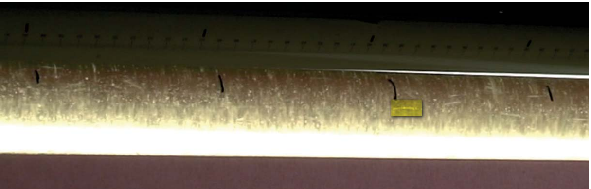
Abbildung 53 Geschwindigkeitsmessung mit einer geradliegenden Faser – 5 Sekunden
