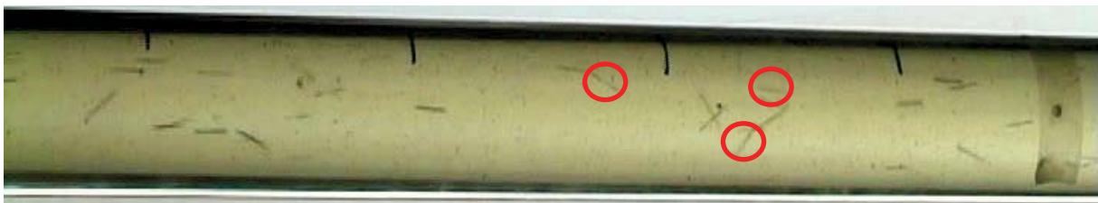
Abbildung 70 Faserbewegung Messzeitpunkt 33 Sekunden (Foto 442)
