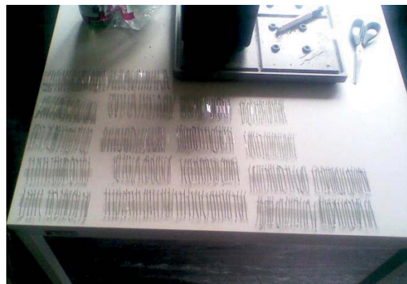
Abbildung 90 Hergestellte Faserketten mit je 20 Fasern zur Kalibrierung
