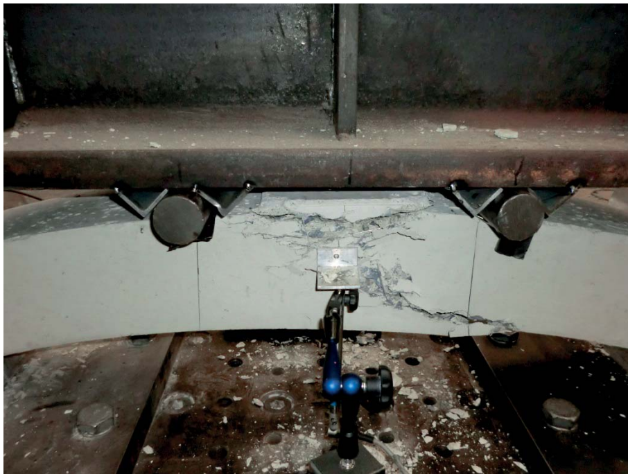
Abbildung 157 Foto des Bruchbildes von Tübbing T2-10
