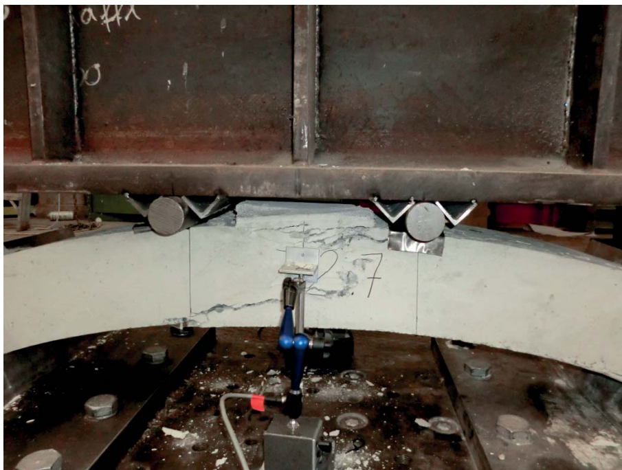
Abbildung 150 Foto des Bruchbildes von Tübbing T2-7
