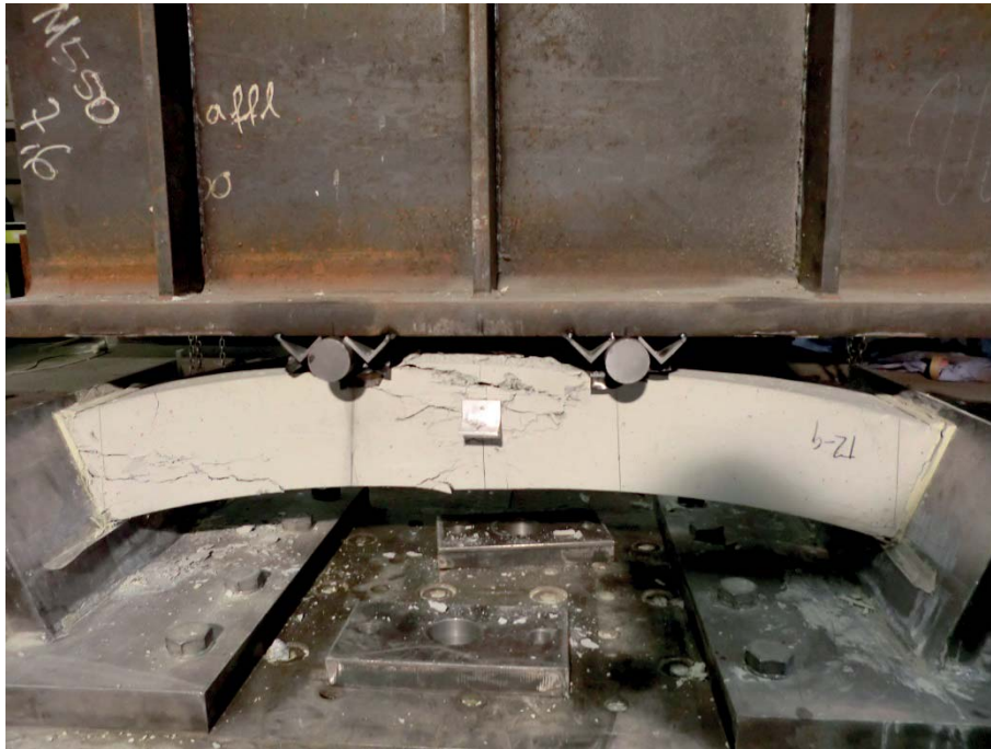
Abbildung 144 Foto des Bruchbildes von Tübbing T2-4
