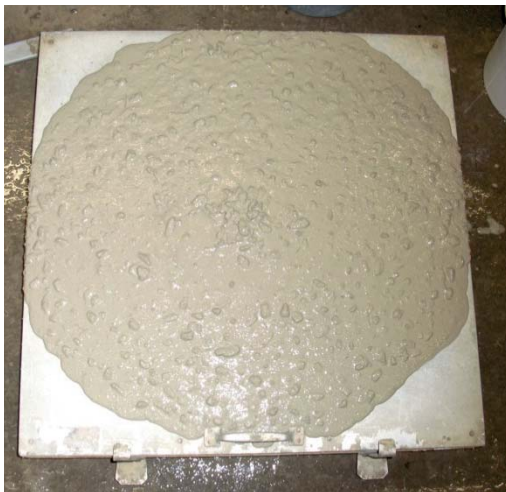
Abbildung 80 Setzfließmaß der Erstprüfung (ohne Fasern)
