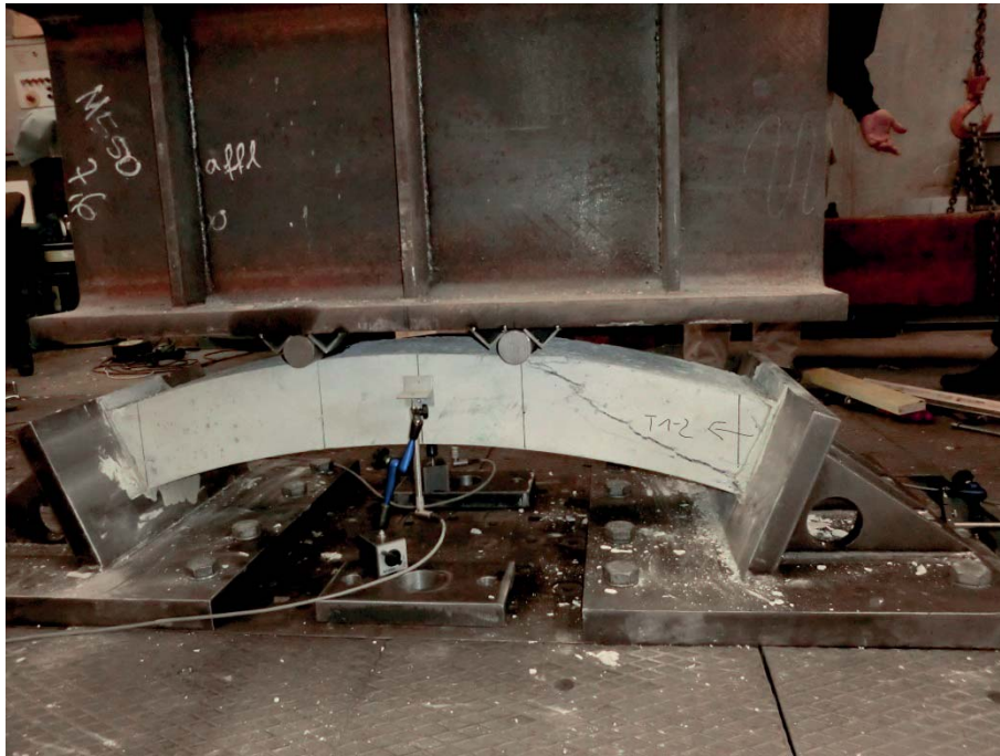
Abbildung 128 Foto des Bruchbildes von Tübbing T1-2
