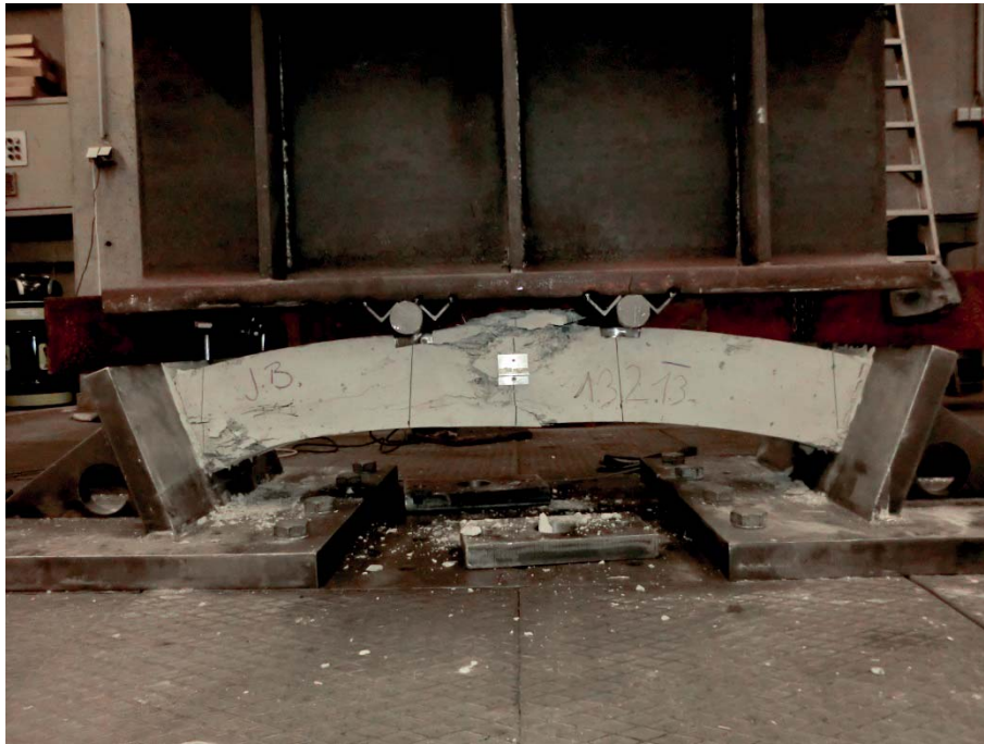
Abbildung 138 Foto des Bruchbildes von Tübbing T2-1
