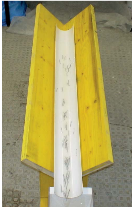
Abbildung 31 Fasern in der Fließrinne
