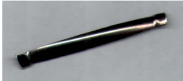
Abbildung 6 Gefräste Stahlfaser (Foto: KrampeHarex)
