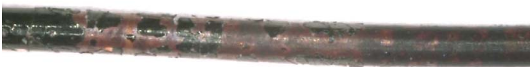
Abbildung 7.24: Mikroskopbild des Drahtstücks (Durchmesser 0,421 \text{ mm} ) mit verdampfter Isolationsschicht nach rein thermischer Belastung des Drahtes.
