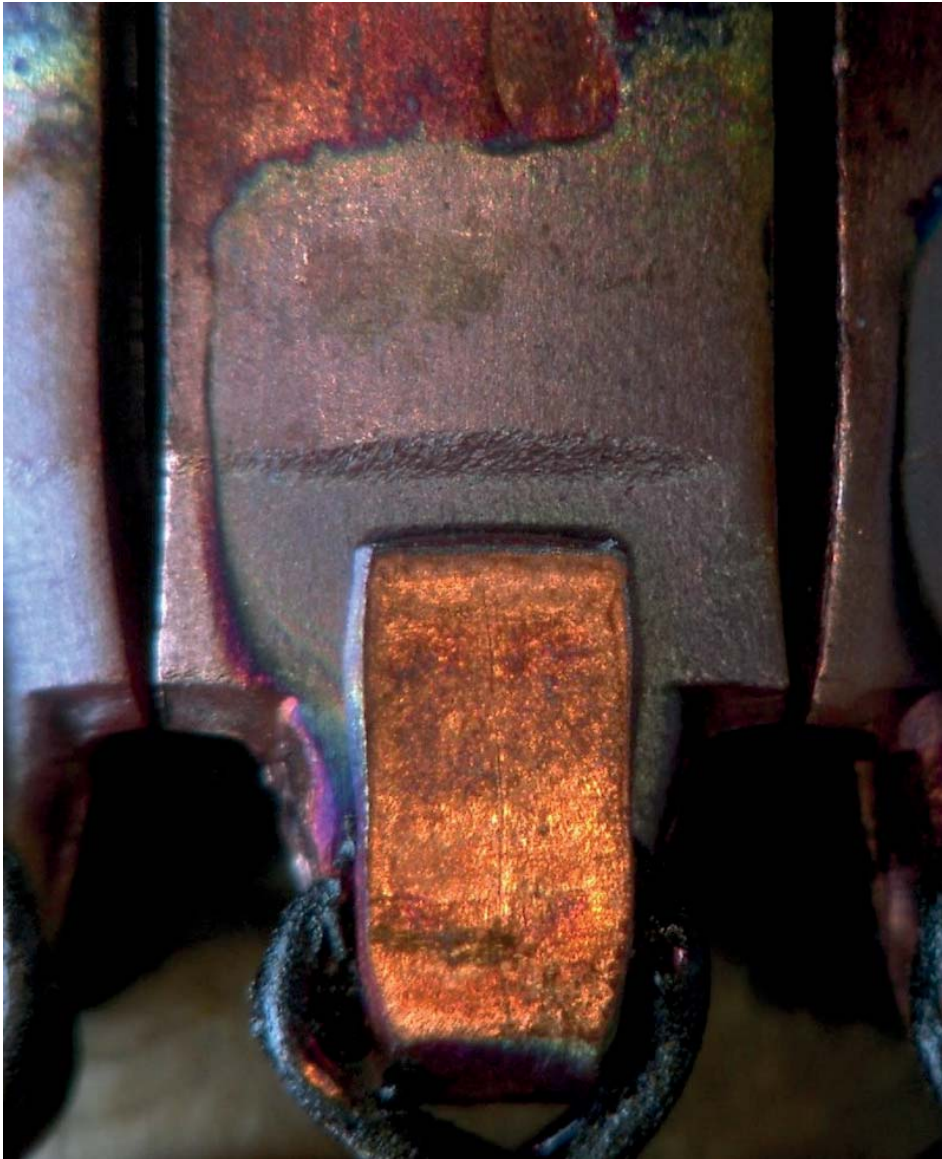
Abbildung 7.2: Haken bei einer Stromflusszeit von 240 ms. Der Haken ist zu stark geplättet, so dass das Scherwerkzeug nicht aufgebracht werden kann. Weiterhin ist der deutliche Lackabbrand außerhalb des Hakens zu sehen sowie die seitliche Verformung der Lamelle, welche zu Kurzschlüssen führen kann.
