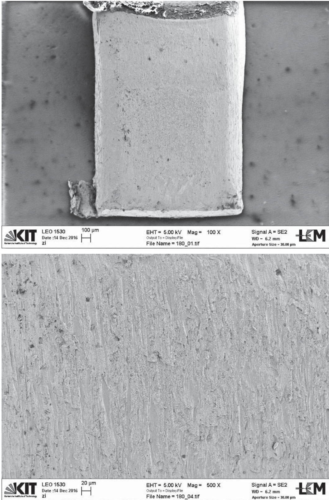
Abbildung 7.31: REM-Aufnahmen der Hakenunterseite bei 180 ms Stromflussdauer.
