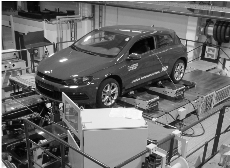
Abbildung 3.7.: Konzept eines dynamischen Kinematics and Compliance-Prüfstands
