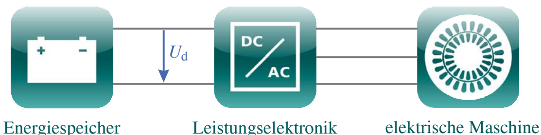
Abbildung 1.1: Prinzipdarstellung des elektrischen Antriebsstrangs in einem Kraftfahrzeug
