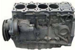
شكل (1): Zylinderbock eines 5-Zylindermotors ( www.t4-wiki.de )
