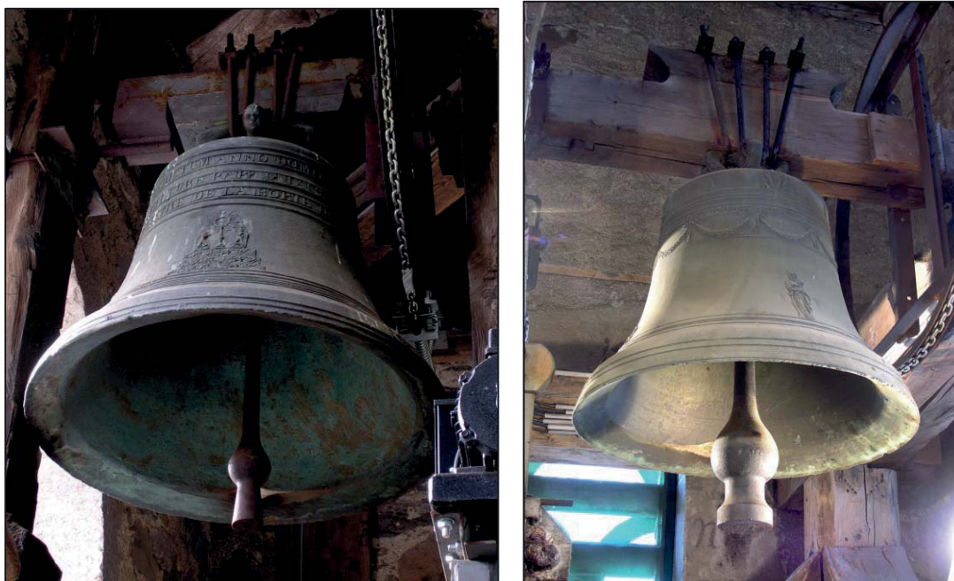
Abbildung 7: Beispiel für einen per se recht gut geformten, aber viel zu klein dimensionierten Klöppel (Verhältnis \varnothing Glocke – \varnothing Klöppel 10:1) (links); Beispiel für einen per se recht gut geformten, aber viel zu groß dimensionierten Klöppel (Verhältnis \varnothing Glocke – \varnothing Klöppel 5:1) (rechts)
