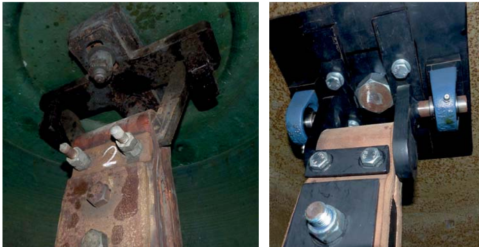
Abbildung 11: Verschiedene Ausführungen von justierbaren Doppelgelenksaufhängungen in Glocken mit Mittelbohrung
