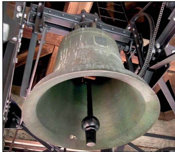
Abbildung 13: Klöppel mit verstärkter Biegesteifigkeit durch nach unten verjüngten Vorschwung. Im Vergleich zum gewohnten, nach unten verbreiteten Vorschwung sparen diese Klöppel bei gleicher Länge Masse ein, wirken in Richtung Hochlastigkeit, beschleunigen weniger und verweilen länger auf der Glocke
