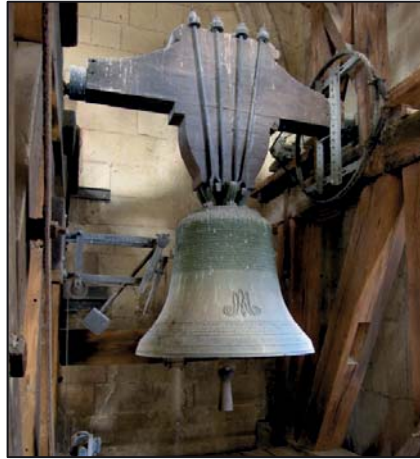
Abbildung 23: System „superlancé“ an einer Glocke der Kathedrale in Nantes (F). Der relativ lange Klöppelvor-schwung bewirkt aufgrund der verhältnismäßig geringen Beschleunigung des träg agierenden Klöppels hier kaum klangliche Nachteile; der Klang wirkt sogar im im Falle einer dicht auf das offene Schallfenster hinzuschwingenden Glocke grundtönig und mild.
