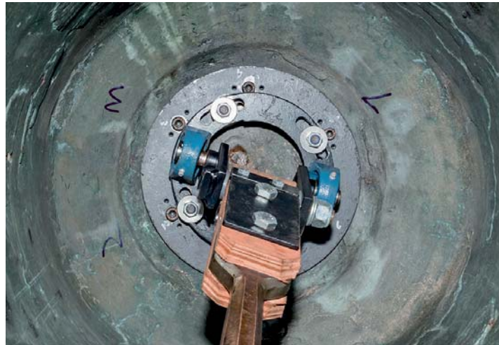
Abbildung 7: Die Ergänzung erfolgte mit minimalen Mitteln durch Bohren von Sacklöchern und Verschrauben des Klöppelrings in den Glockenboden. Unter Verwendung von M10 Normgewindeimbusschrauben.
