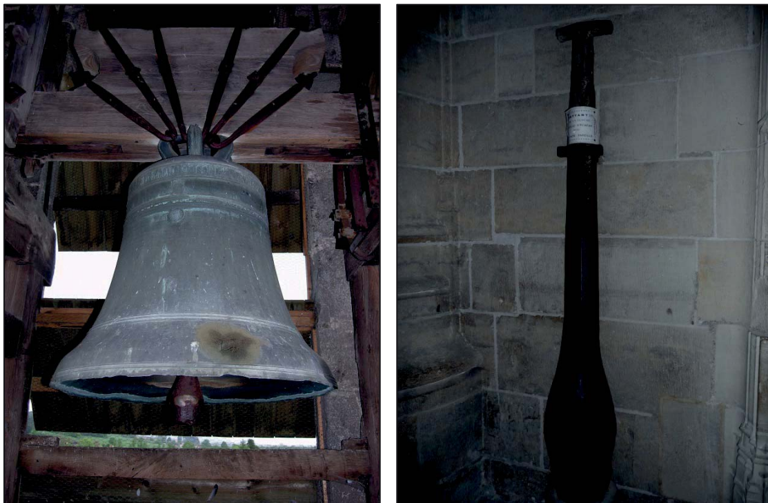
Abbildung 10: Historische Klöppel, beide mit dem Extrem des verschwundenen Vorschwungs und zugleich totaler Biegesteifigkeit
