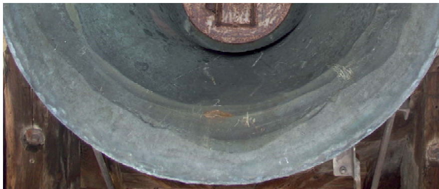
Abbildung 9: Breite Anschlagflächen mit hohem Materialabtrag aufgrund sehr schlechter Klöppelführung
