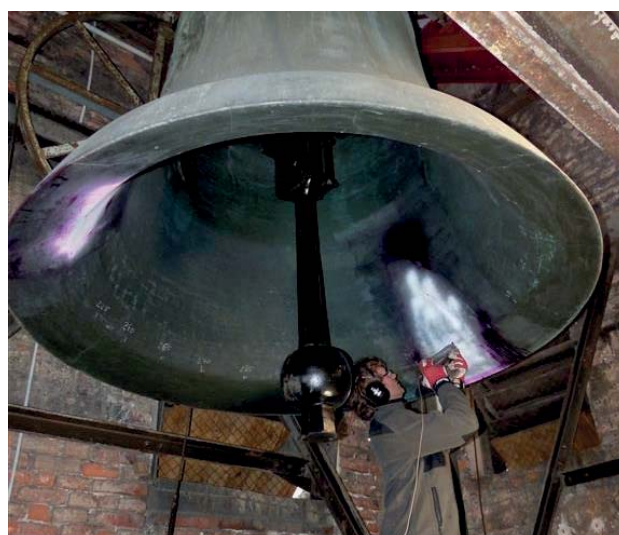
Abbildung 7: Klangmessungen über den Umfang der Glocke (Jubiläumsglocke, München)
