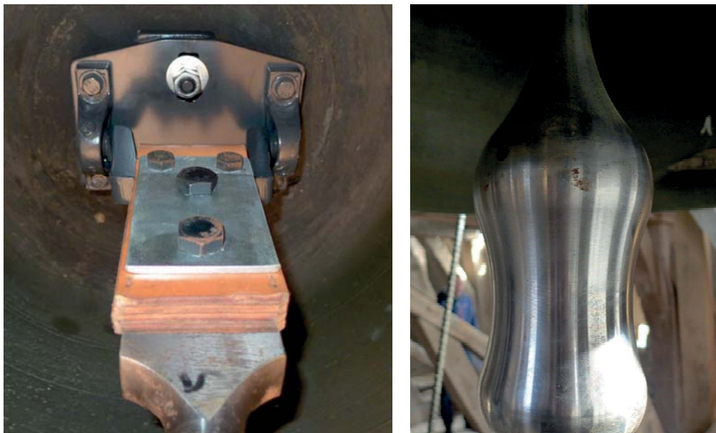
Abbildung 3: Klöppelinstallation an justierbarer Doppelgelenkaufhängung (links), Form des Klöppels von Glocke 4 (rechts)
