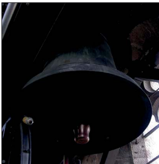
Abbildung 11: Moderner Klöppel von 2016, prinzipiell mit denselben formalen und musikalischen Eigenschaften wie die historischen Klöppel der vorangehenden Abbildungen
