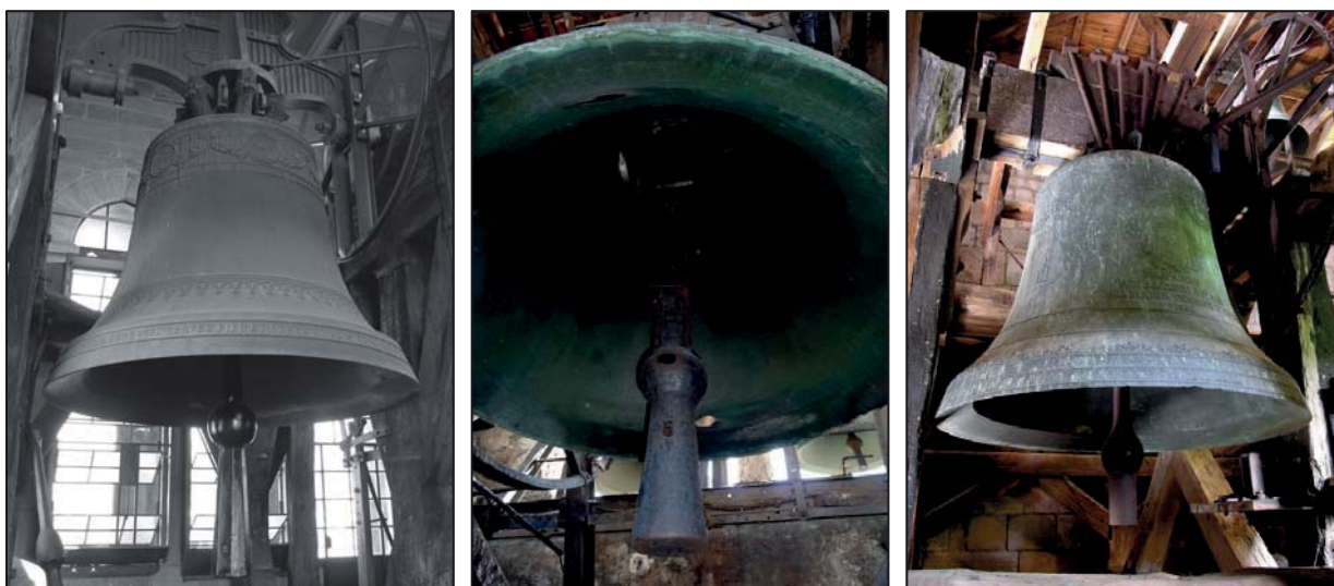
Abbildung 8: Klöppel mit überaus langem Vorschwung, der durch die kegelartige Verbreiterung nach unten sowie den schlanken Schaft klanglich ein besonders enttäuschendes Ergebnis zeitigt (links); Klöppel mit sehr langem Kegel-Vorschwung, dessen klangliche Nachteile allerdings durch einen sehr kräftigen Schaft und biegesteife Übergänge entschärft werden (mitte); Klöppel mit recht kurzem und geradem Vorschwung und kräftigem Schaft. Solche Proportionen bewirken klanglich ein sehr grundtöniges Resultat (rechts)
