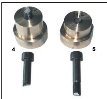
Abbildung 6: Eine Prüfung ergab bei 886.196 Lastwechseln in 144 Stunden, bei einer Last von 20kN und einer Auslenkungskraft von 5kN (schwingend) unter einer Frequenz von 154,1Hz (Bruch der Schraube). Die Gewindeanschlüsse in den Sacklöchern wurden nicht geschädigt, der Bruch erfolgte beides Mal im freien Schaftbereich (Schwingungsbereich) der Schraube
