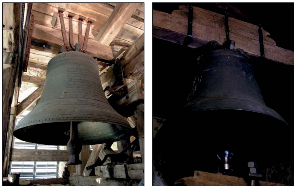
Abbildung 12: Klöppel mit kurzem Vorschwung, der durch den relativ dicken Schaft hochlastig wird (links); Klöppel mit etwa derselben Vorschwunglänge, der aber durch die starke Ausbreitung bei gleichzeitig geringer Ballenmasse und sehr schlankem Schaft eine Tieflastigkeit mit entsprechend kurzer Berührungszeit und eher durchschnittlichem Klangergebnis generiert (rechts)
