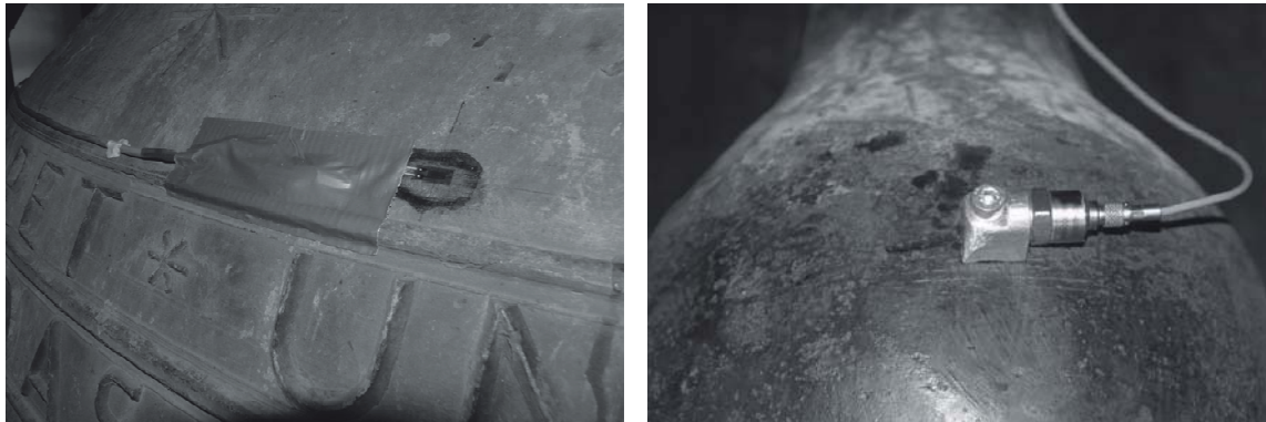
Abbildung 3: Applizierter DMS auf der Glocke (links), Beschleunigungssensor am Klöppel (rechts)
