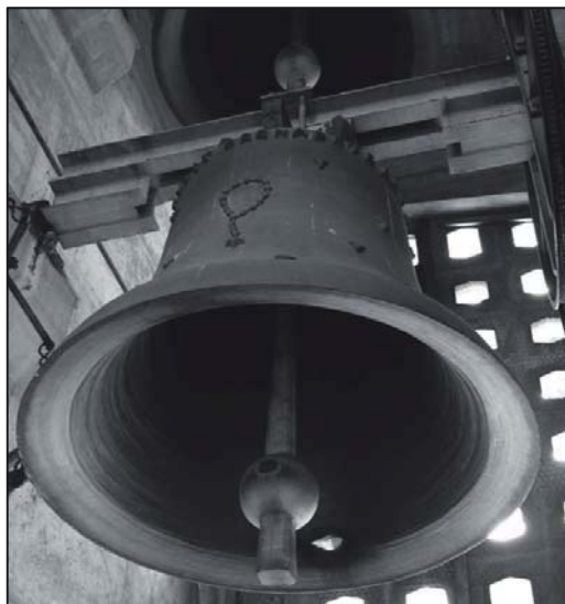
Abbildung 6: Klöppeltyp mit großer Kugel und verhältnismäßig leichtem, kleinen Vorschwung, wie ihn die Gießerei Bachert in Karlsruhe im Anschluss an Theo Fehns Experimente in Speyer häufig entwarf
