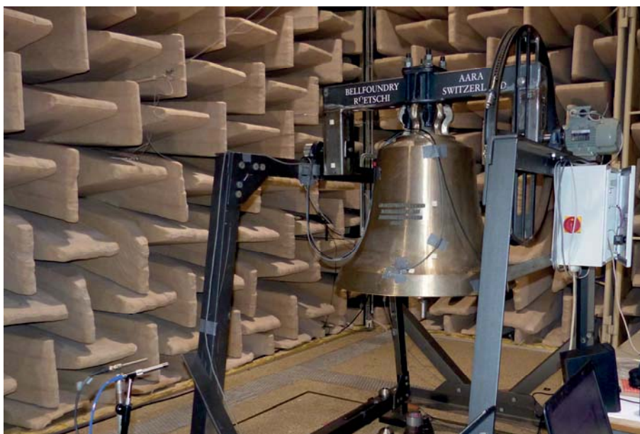
Abbildung 5: Versuchsglocke c'' mit einem Stahljoch mit veränderbarer Kröpfung
