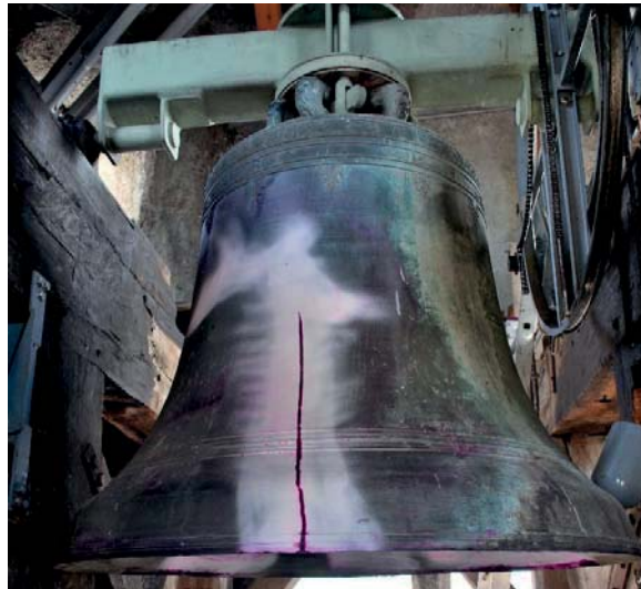
Abbildung 1: Farbeindringprüfung an einer gesprungenen Glocke
