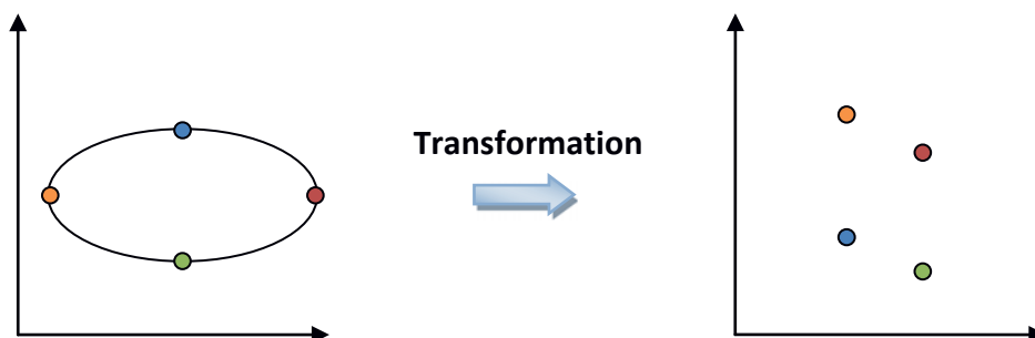
Abbildung 27: Schematische Darstellung des Prinzips der nichtlinearen Unscented-Transformation
