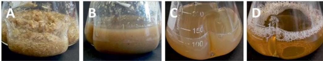
**Abbildung 4.24** – A - Beginn der Hydrolyse von alkalisch vorbehandeltem Weizenkaff, B - Weizenkaffhydrolysat nach 6,6 Tagen mit Biogazyme 2x bei 50 °C und pH 4,8, C - Weizenkaffhydrolysat nach der Abtrennung des nicht-hydrolysierten Weizenkaffs, D - konzentriertes Weizenkaffhydrolysat.
