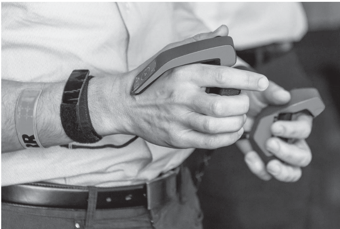
Abb. 3: Interaktive Prototypen der mobilen Fernbedienung zur Baggersteuerung
