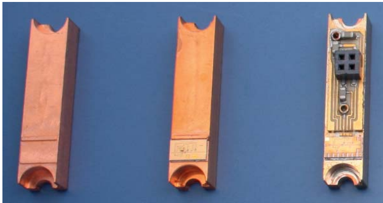
Abbildung 5.1: Kupferflansche. links: unbestückter Flansch mit Podest, mitte: Flansch mit MMIC-Schaltung auf dem Podest, rechts: voll bestückter Flansch mit DC-Platine und MMIC verbunden über bondbare Kapazitäten.
