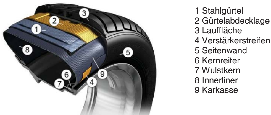
Abbildung 2.12: Reifenaufbau am Beispiel eines Radialreifens [26]
