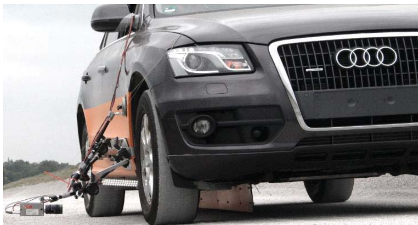
Abbildung 4.8: Versuchsaufbau des fahrzeugfesten Kamerasystems am Versuchsfahrzeug
