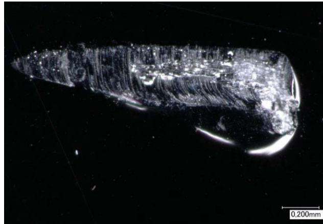
Abbildung 6.12: Einschlagsform 4 ist ein Kanteneinschlag des Projektils ohne Rotation, aufgenommen mit dem Licht-Mikroskop. Fallturmversuch mit Dodekaeder (Projektil 5) bei 21° Auftreffwinkel und 30 mJ Aufprallenergie.
