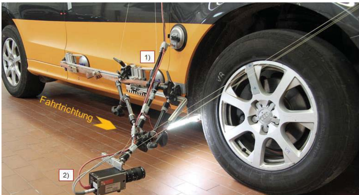
Abbildung 4.2: Versuchsaufbau des fahrzeugfesten Kamerasystems zur Analyse des Abwurfmechanismus von Steinen.
