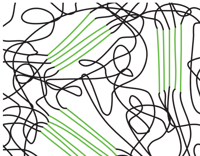
Abbildung 20: Modell-Darstellung der Polymerstruktur eines teilkristallinen Thermoplasten mit Kennzeichnung der kristallinen Bereiche in grün.
