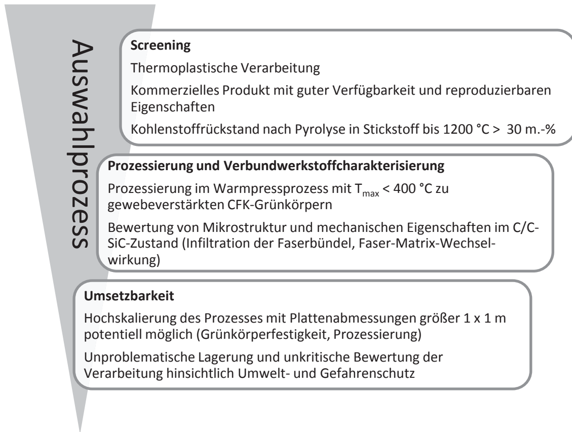
Abbildung 2: Auswahlkriterien für die thermoplastischen Kohlenstoffprecursoren.
