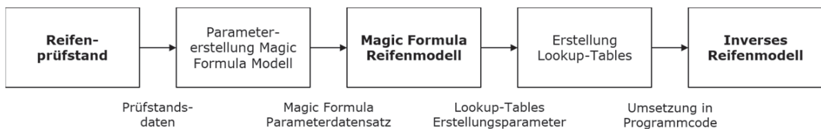
Abbildung 8.6: Erstellung inverses Reifenmodell (Ernst 2016, S. 38)
