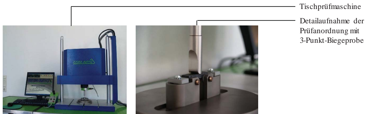
Abbildung 4-5: Servopneumatisch gesteuerte Vertikal-Prüfmaschine und Versuchsanordnung zur dynamisch-schwellenden Prüfung im 3-Punkt-Biegeversuch.
