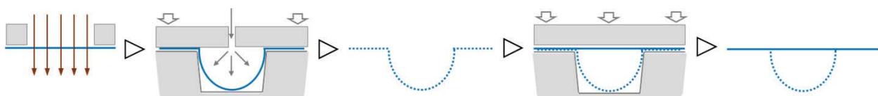
Abbildung 66: Schematische Darstellung der SMART-Technologie zur Herstellung der vasQchips (nach S. Giselbrecht et al., 2008 44 ). Die PC-Folie wird durch Schwerionenbeschuss vorbehandelt und anschließend durch Thermoformen mit Hitze und Druck (147 °C, 4 bar, 5 min) die Kanalstruktur geformt. Durch einen Ätzvorgang (70 °C, 4,5 h in 5 M NaOH und 0,01 % Dowfax™) entstehen an den Ionenspuren Poren in der Membran. Abschließend wird der Kanal mit einer weiteren Folie durch Thermobonden (145 °C, 20 MPa, 2 min) verschlossen.
