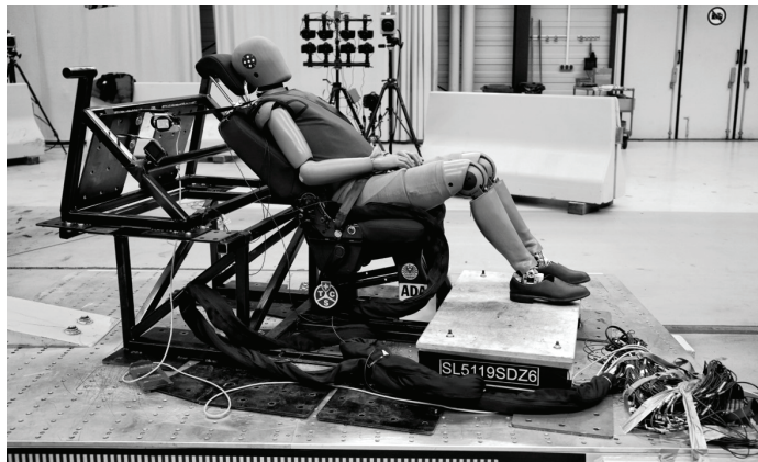
Abbildung 2: Versuchsaufbau der Schlittenversuche
