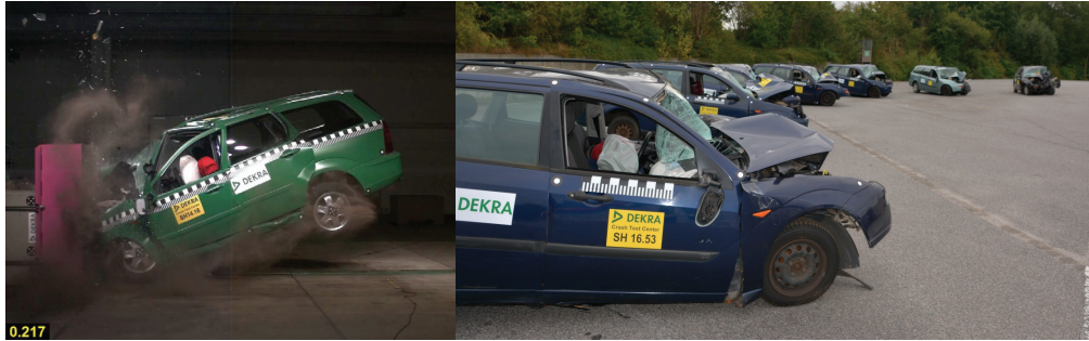
Abbildung 3: Versuchsfahrzeuge mit fahrerseitigem Anprall, 60 % Überdeckung, 84 km/h, nicht deformierbare Barriere
