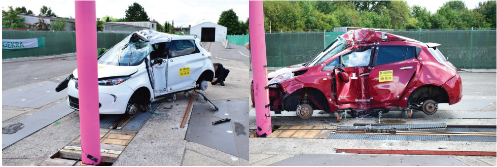
Abbildung 6: Post-Crash-Zustand des Renault Zoe und Nissan Leaf nach einem 90°-Pfahlanprall mit 60 km/h
