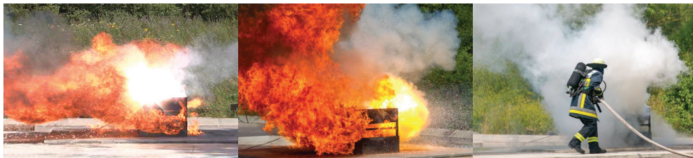
Abbildung 5: Brand- und Löschversuche mit Li-Ion-Antriegsbatterien
