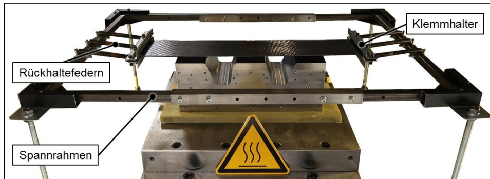
Bild 4: Spannrahmen zum Transport der Organobleche vom Ofen in die Presse
