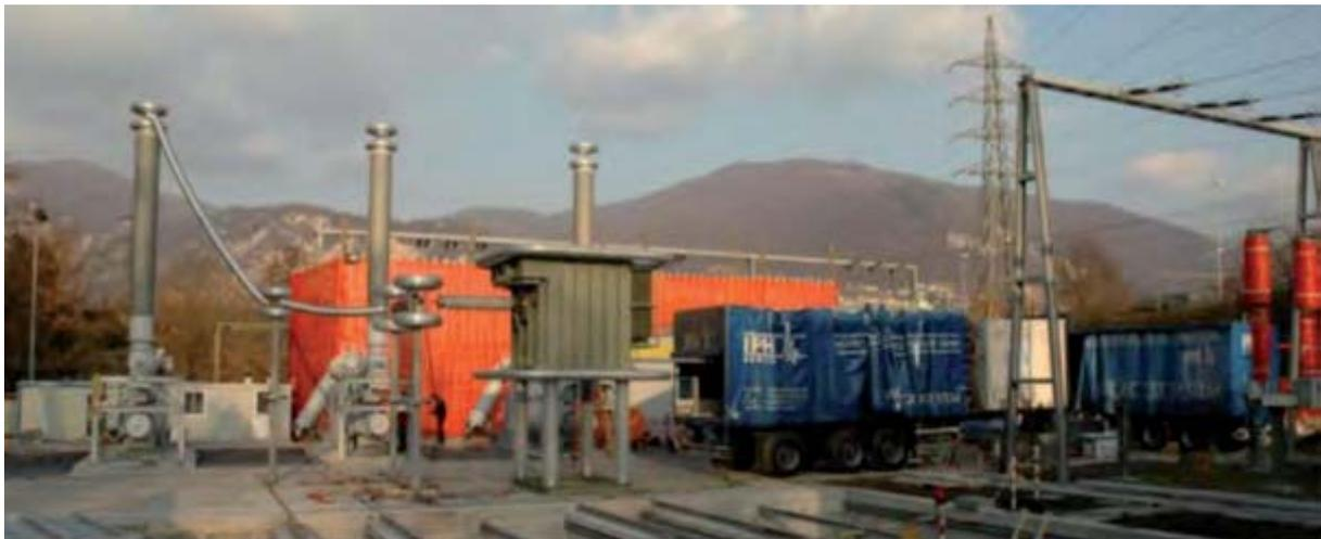
**Abbildung 1.23** Hochspannungsprüfung bei einem 380-kV-Kabel (630 mm<sup>2</sup>, 560 MVA) Mendrisio Cagno [21]
