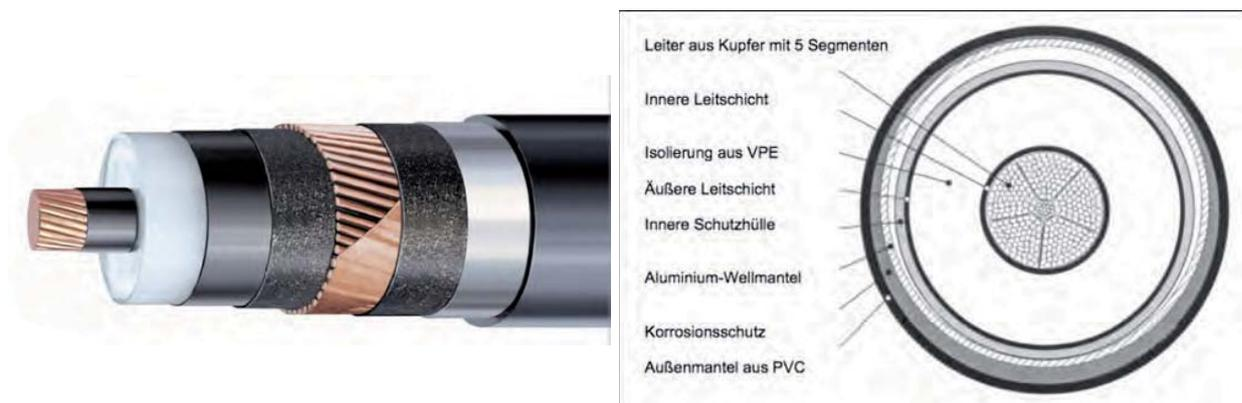
**Abbildung 1.14** 380-kV-VPE-Kabel (Quelle: Brugg Cables)
