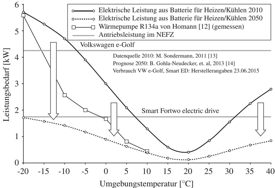
**Abbildung 1.1:** Stationäre Leistungsaufnahme des Heiz- und Kühlsystems mit Widerstandsheizung für ein batterieelektrisches Fahrzeug im Jahr 2010 und geschätzt für das Jahr 2050 ([14], [13]); zudem ein Wärmepumpensystem mit dem Kältemittel R134a [12].
