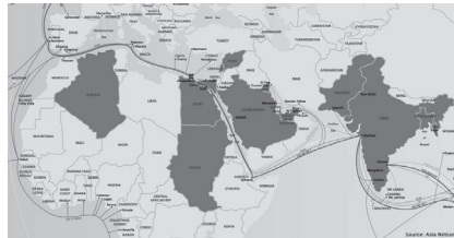
Abbildung 1.2: Charakteristik eines Ausfalls: Nachdem im Jahr 2008 zwei Unterseekabel ausfallen, welche den Mittleren Osten mit Indien verbinden, bricht die Konnektivität unter anderem in weiten Teilen von Ägypten und Indien zusammen (stark betroffene Länder sind dunkel hervorgehoben). Die Ursache des physikalischen Ausfalls ist bis heute nicht geklärt. [Zmi08]
