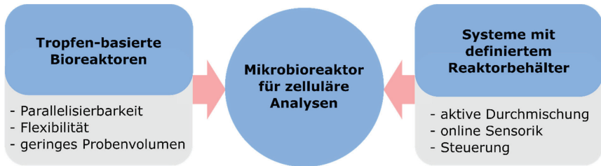
Abbildung 1.1: Zielstellung der Dissertation: Kombination der Vorteile der Konstruktion von Kultivierungssystemen, die Tropfen-basiert und mit definiertem Reaktorbehälter arbeiten.
