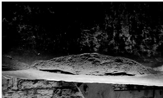
Abb. 2: Schlagverschleiß am Anschlag
