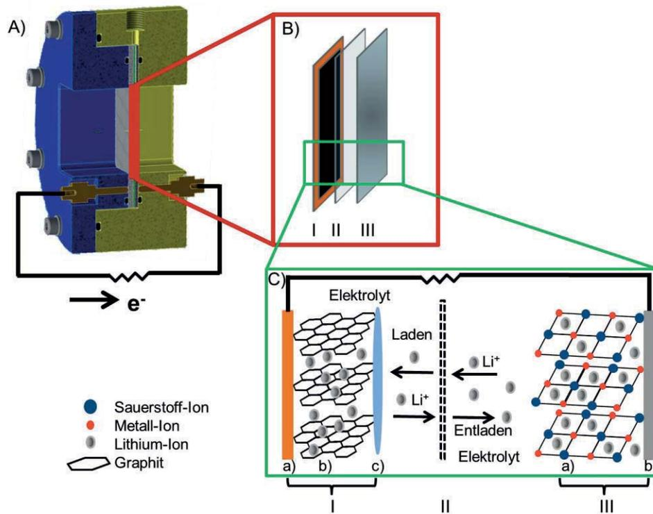
**Abbildung 1:** A) Schematischer Aufbau einer Lithium-Ionen-Zelle am Beispiel der selbstkonstruierten Laborzelle. B) Vergrößerung der Anordnung der I) Anode, II) des Separators und III) der Kathode. C) Schematische Erläuterung des Lade- und Entladevorgangs mit den einzelnen Komponenten I a) Kupferableiter, I b) Graphitschicht, I c) SEI-Schicht, II) Separator, III a) Kathodenmaterial  $\text{Li}_{1-x}\text{CoO}_2$  und III b) Aluminiumableiter.
