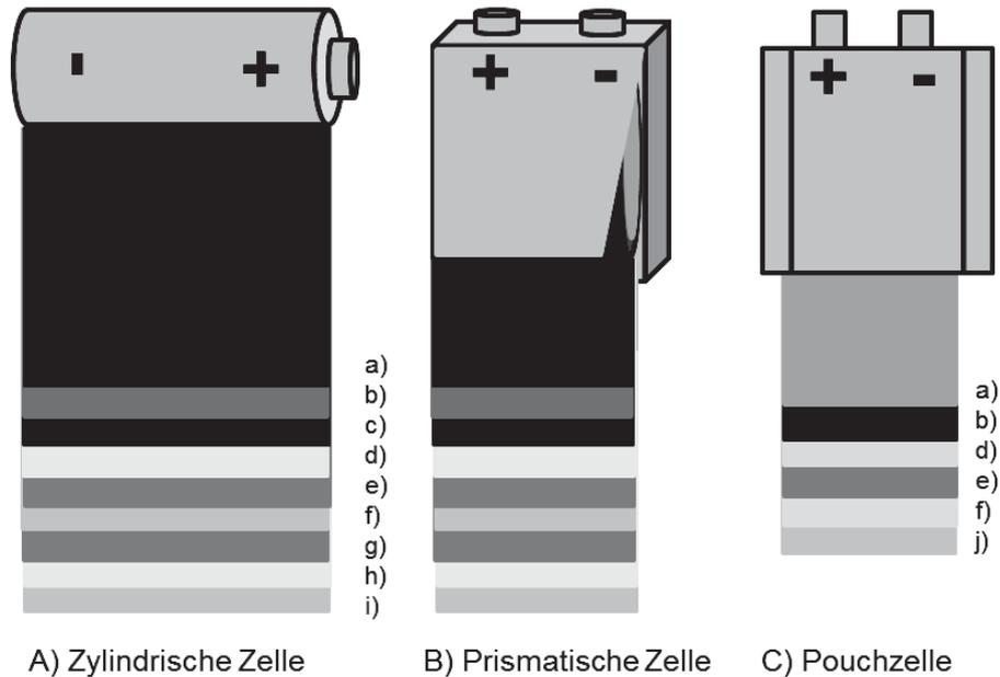
**Abbildung 3:** Aufbau einer zylindrischen (A), einer prismatischen (B) und einer Pouchzelle (C) mit a) und c) die Anodenbeschichtung, b) der Kupferableiter, d) und h) der Separator, e) und g) die Kathodenbeschichtung, f) der Aluminiumableiter, i) das Gehäusematerial und j) eine mit Kunststoff beschichtete Aluminiumfolie.
