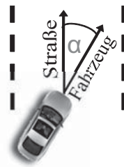
Abbildung 1.4.: Winkel des Fahrzeugs zur Straße
