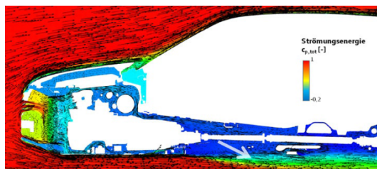
Abbildung 2.4: Strömungsenergie der Kühlluft [44]
