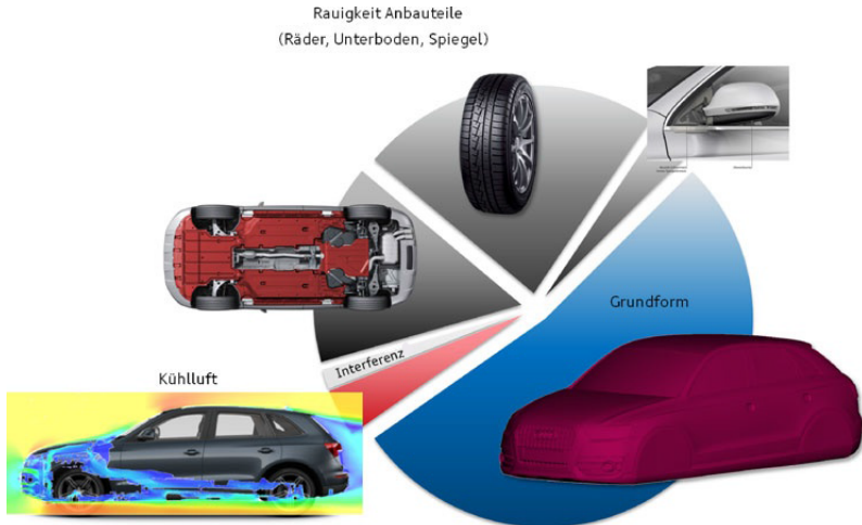
Abbildung 2.3: Zusammensetzung des Luftwiderstandes [44]
