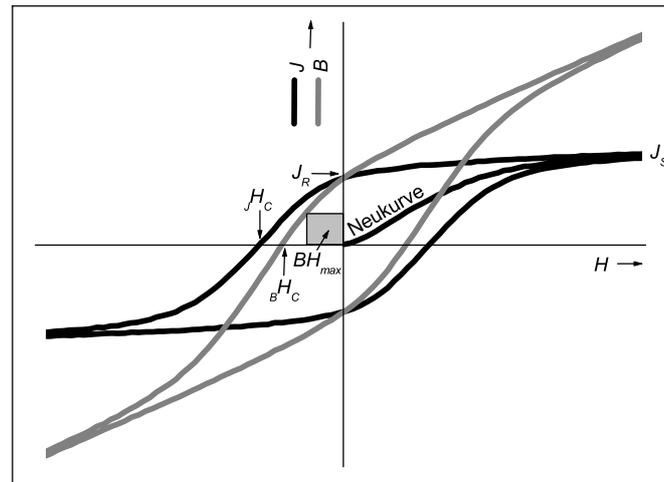
**Abbildung 2.3:** Ferromagnetische Hysterese in  $J(H)$ - und  $B(H)$ -Auftragung mit  $B = \mu_0 H + J$ . An der Hysterese sind die Kenngrößen Remanenz  $J_R$ , Koerzitivfeldstärke  $H_C$  und das als Fläche in  $B(H)$  aufgetragene maximale Energieprodukt  $BH_{max}$  eingetragen.
