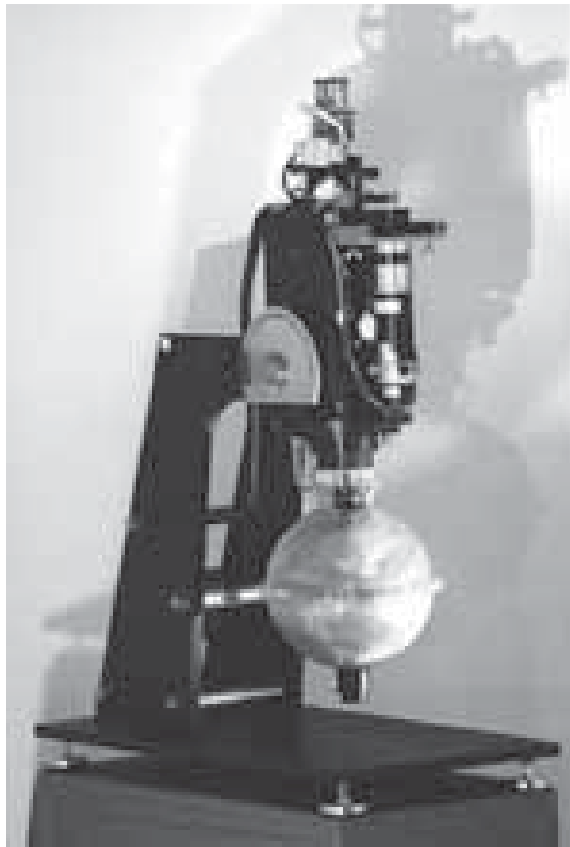
Abbildung 2.2: Experimentaufbau zur Untersuchung der Strömungszustände im weiten Kugelspalt [44].
